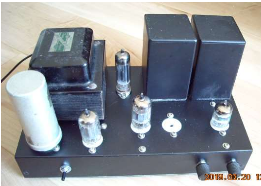
Photo 5 出力管が 12AU7(5814)の場合
